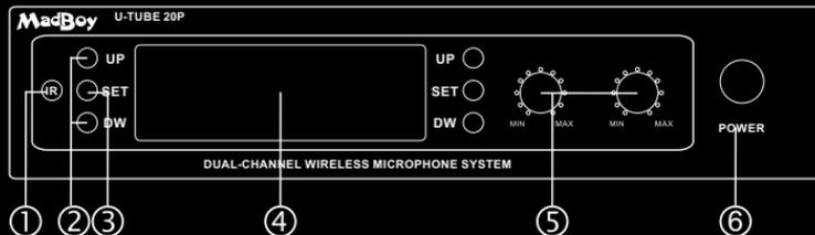
1. Инфракрасный порт (IR) (отправляет сигнал на микрофон для синхронизации)
